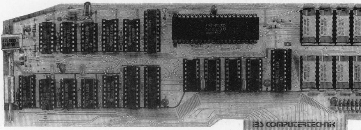
Ihre CP/M – Programme laufen 3 (4) mal schneller mit der schnellen Z80 – Karte von IBS. Die Karte wird einfach in irgendeinen Slot eines Apple II, Apple IIe oder Apple-Kompatiblen-Rechners gesteckt.
